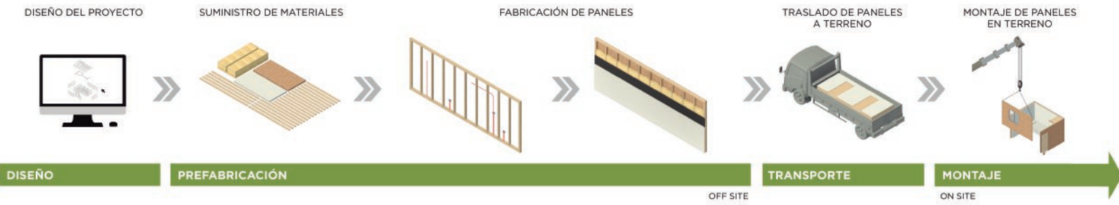
Figura 9. Esquema fases constructivas proceso industrializado
