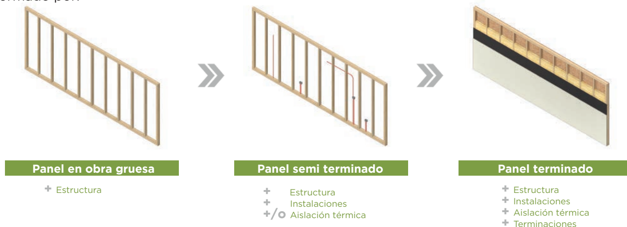
Figura 8. Niveles de prefabricación de un panel
