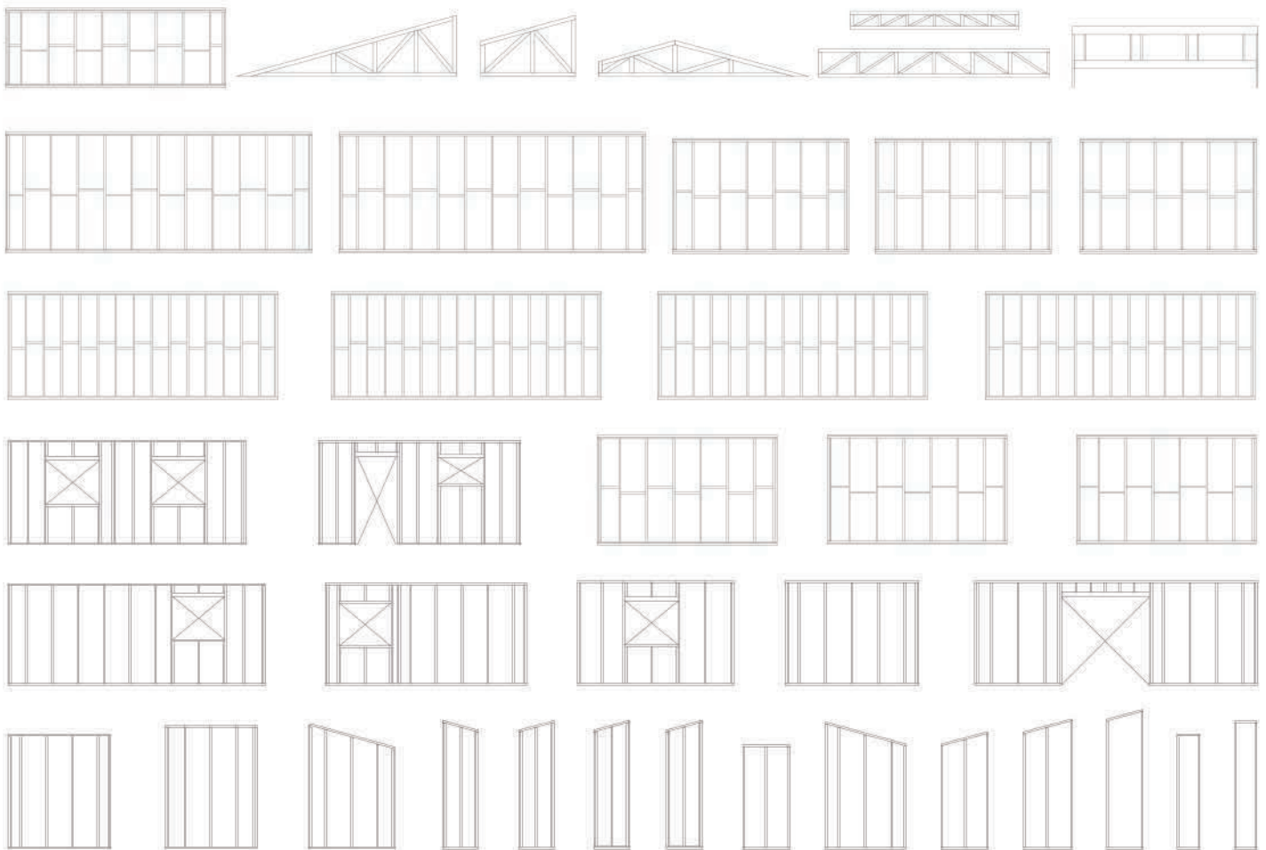
Figura 20. Despiece de paneles que componen la vivienda
