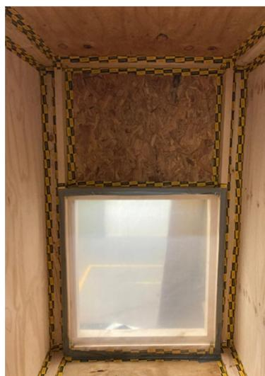
Figura 83: sellos interiores del módulo de ensayo
