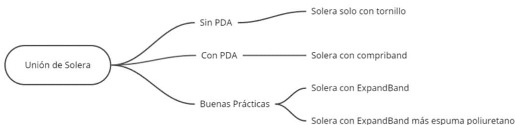
Figura 94: uniones de solera ensayadas.
