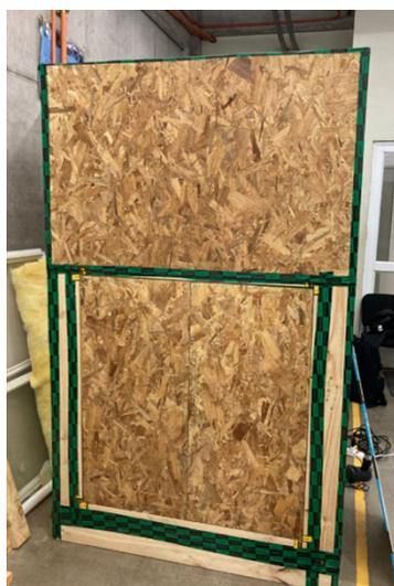
Figura 82: elevación 04 módulo de ensayos con sellos.
