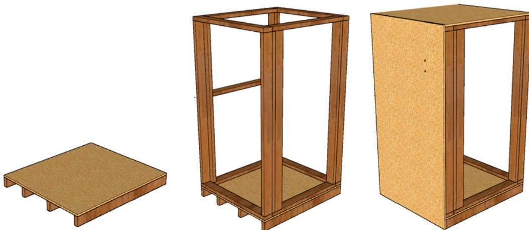
Figura 79: a) estructura de la base del módulo; b) estructura principal del módulo y c) elevación 01
