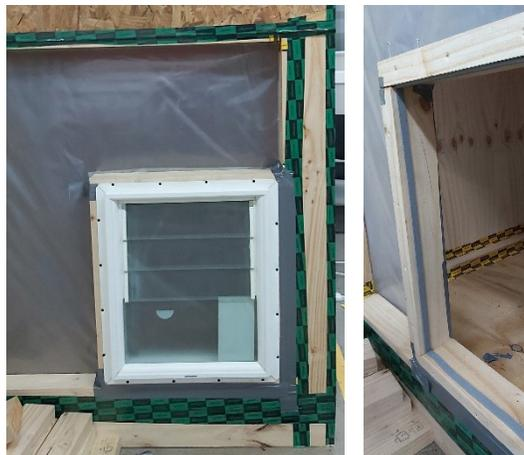
Figura 86: Imágenes del ensayo de unión de ventana
