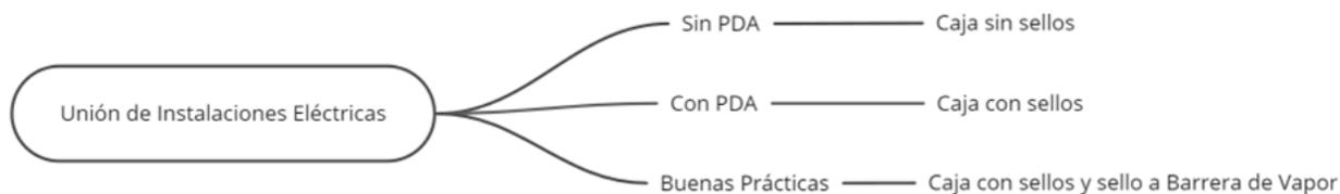
Figura 98: Soluciones de unión de instalaciones eléctricas ensayadas.
